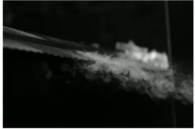
(d) Flow past a sawtooth serrated edge at 5° AoA.
