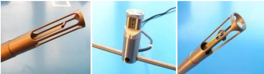
Figura 2. Izquierda: sonda de escaneo (1D velocidad). Centro: sonda PU (presión y velocidad 1D). Derecha: sonda USP (presión y velocidad 3D).
