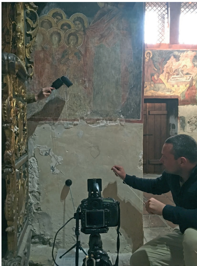
Обр. 1. Процес на RTI заснемане на панел от югозападния пиласٹر. Снимка – З. Георгиева
