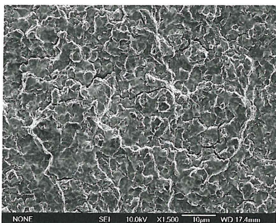
Figure 5-14e: U720Li-LP; 650°C 1-1-1-1 Air ( \Delta K \approx 24.3 \text{ MPa}\sqrt{\text{m}} ).
