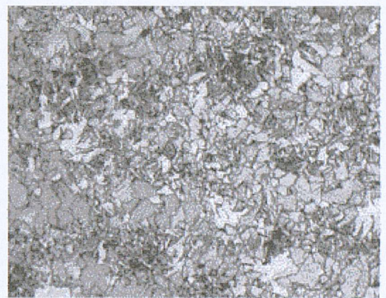
(d) Microstructure of HAZ, \times 500
