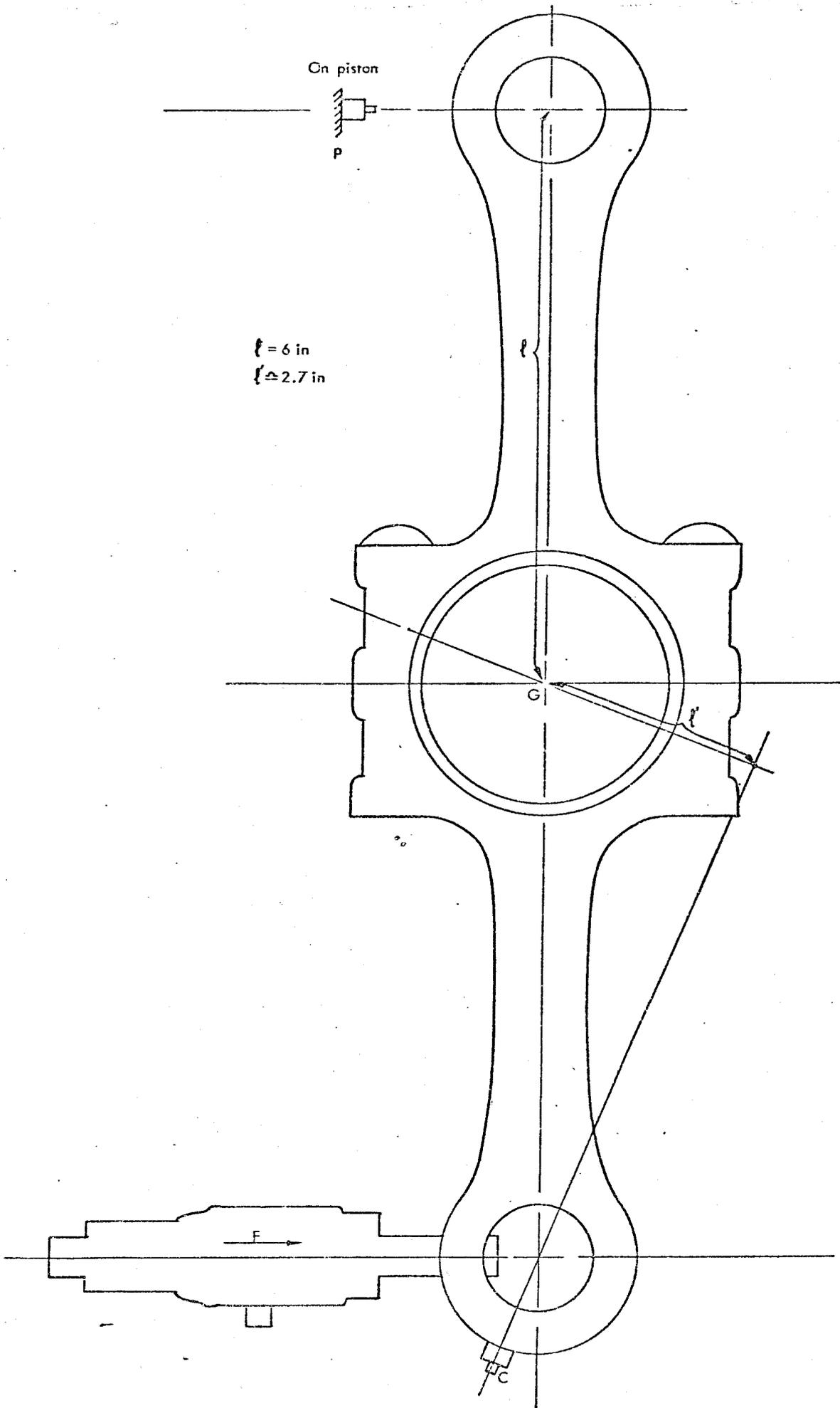
FIG 1A BACK TO BACK CONNECTING ROD SYSTEM
