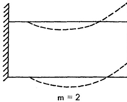
FIG. 1D.b SOME FORMS OF VIBRATION OF THIN CYLINDERS
