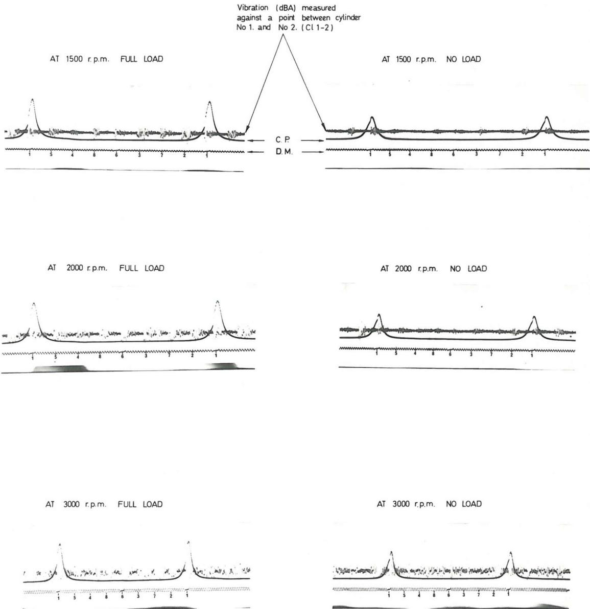
FIG. 4.12 CYLINDER BLOCK VIBRATION BETWEEN ADJACENT CYLINDERS (SA)
