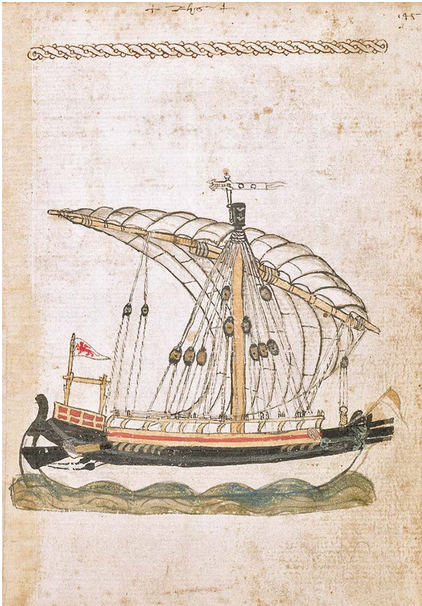
Обр. 16 Илюстрация на синхронно използване на странични рулове и централен кърмови рул при галера от ръкописа на Михаил Родоски от около 1434 г., изображение: [ https://www.medievalists.net/2011/01/fleet-operations-in-the-first-geoese-venetian-war-1264-1266/145b_o_small/ ]
