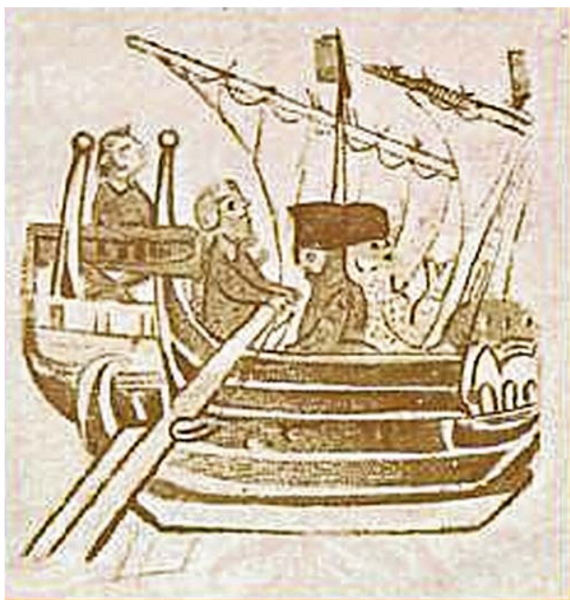
Обр. 17 Образец на задно закрепване на странични рулове при галера, изображение: по (Pryor, 1988, корица)
